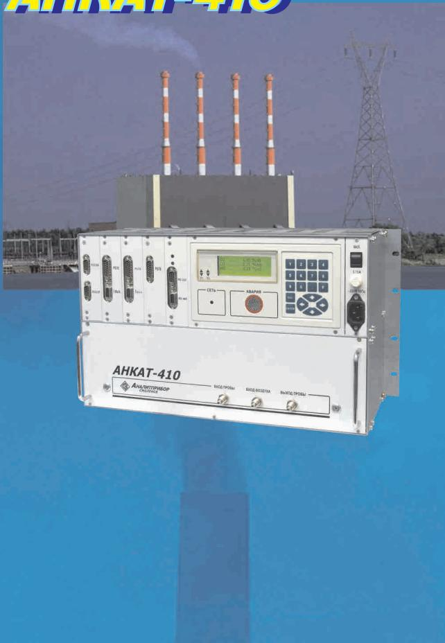
Предназначен для непрерывного экологического и технологического контроля топливосжигающих и технологических установок, измеряет концентрации O<sub>2</sub>, CO, CO<sub>2</sub>, NO, NO<sub>2</sub>, SO<sub>2</sub>, H<sub>2</sub>S, HCl, NH<sub>3</sub>, Cl<sub>2</sub>, а также для анализа отработавших газов (CO, NO, NO<sub>x</sub>, ΣCH) тепловозов и других дизельных двигателей.
